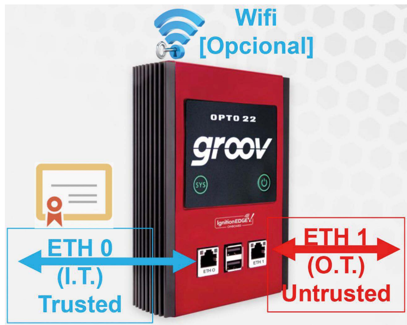
■ Groov Box es un servidor industrial conectable a tres redes independientes separadas.
